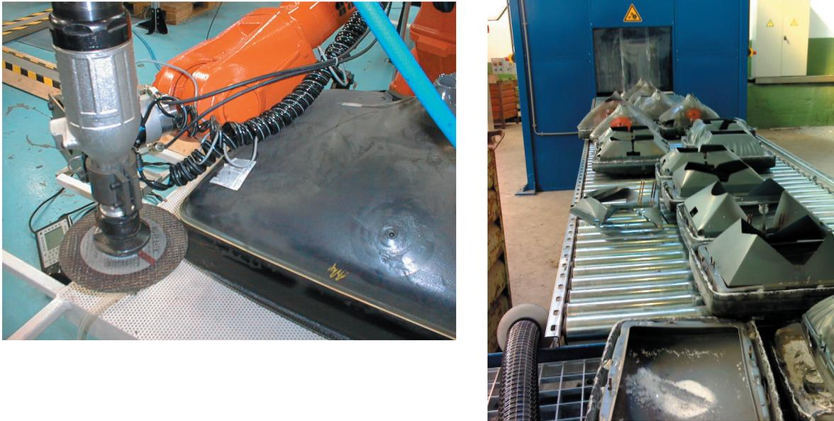
**Figura 5.** Detalle de la operación de corte robotizado del TRC y línea de salida de material de TRCs
