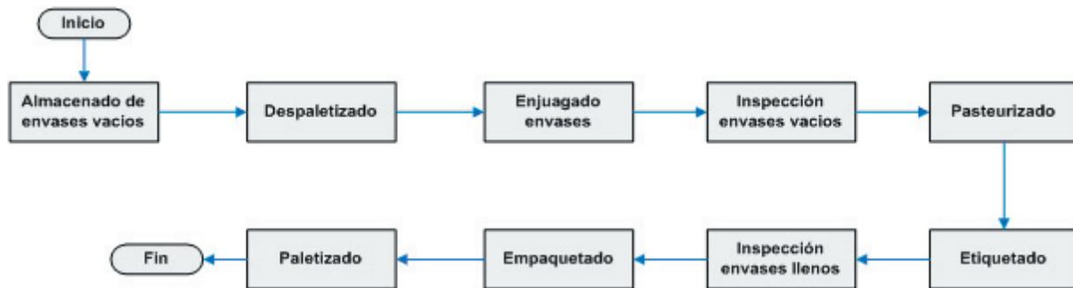
Figura 3. Esquema operativo del tren de envasado
