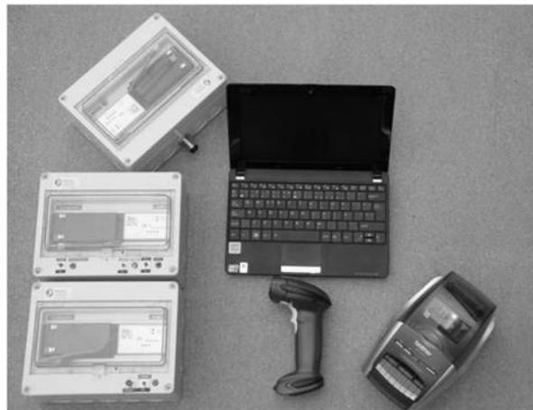
**Figura 4.** Componentes del Plug&Lean System. Colectores, sensores, gateway y laptop
